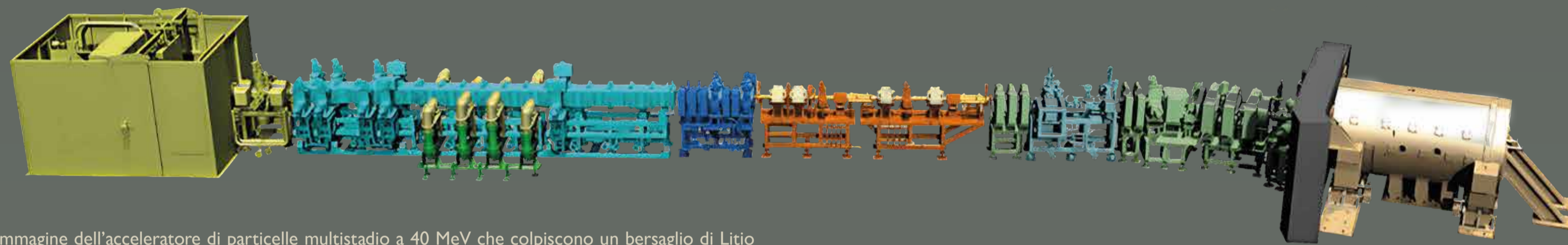
Immagine dell'acceleratore di particelle multistadio a 40 MeV che colpiscono un bersaglio di Litio producendo così i neutroni a 40 MeV per collaudare i nuovi materiali che dovranno essere utilizzati nella camera toroidale del reattore.
