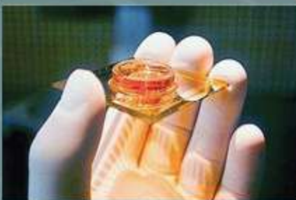
Matrici di Micro Elettrodi per applicazioni in vitro
