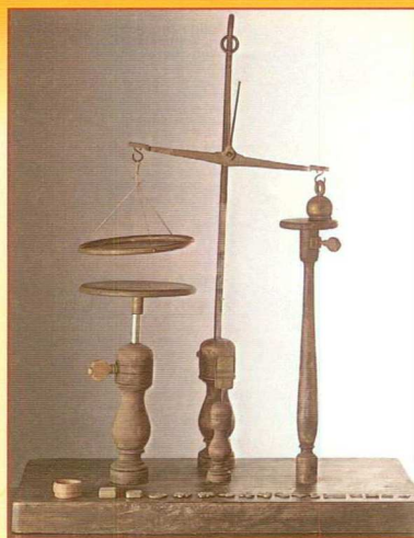
Bilancia elettrostatica di Volta
