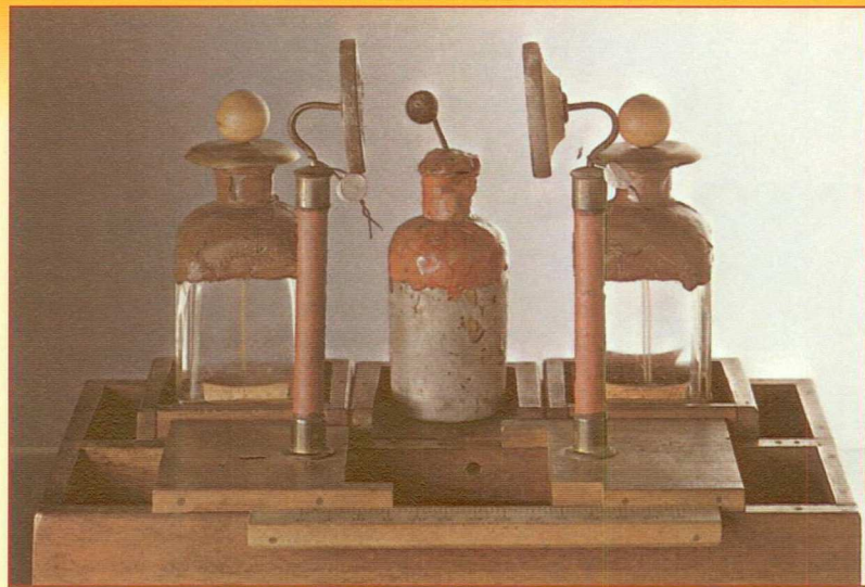
Apparecchio per lo studio dei conduttori coniugati e della dipendenza della capacità dalla distanza
