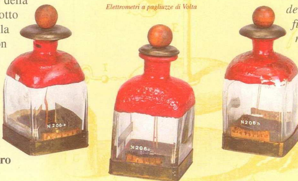
Elettrometri a pagliuzze di Volta
