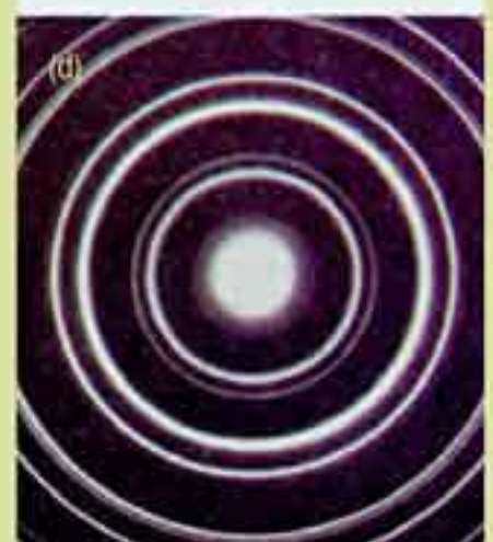
Diffrazione di raggi X (a) e di elettroni (b) da polveri di ossido di zirconio. Diffrazione di raggi X (c) e di elettroni (d) da un monocristallo di oro
