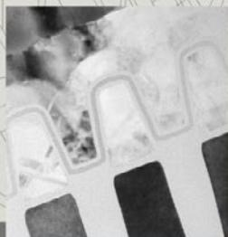
Immagine al microscopio elettronico a trasmissione del dettaglio di una memoria Flash di tipo NAND. Nell'immagine si vedono tre celle di memoria, delle dimensioni di circa 50nm (il nanometro è un milionesimo di millimetro ed è dieci volte la dimensione dell'atomo).
