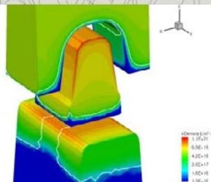
Simulazione tridimensionale di una cella di memoria Flash di tipo NAND; la soluzione numerica delle equazioni del campo elettrico e del trasporto di carica consente di calcolare la densità di elettroni di conduzione, evidenziata con una scala di colori.
