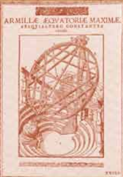
La grande armilla equatoriale usata da Tycho per misurare le posizioni di stelle e pianeti
