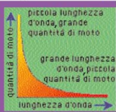
RELAZIONE FRA L'ENERGIA DELLA PARTICELLA E L'ESTENSIONE DELLA SUA FUNZIONE D'ONDA.
